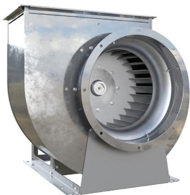
Вентиляторы серии ВРВ общепромышленного назначения представляют собой радиальные вентиляторы с загнутыми вперед лопатками специальной формы с рабочим колесом левого или правого вращения.
